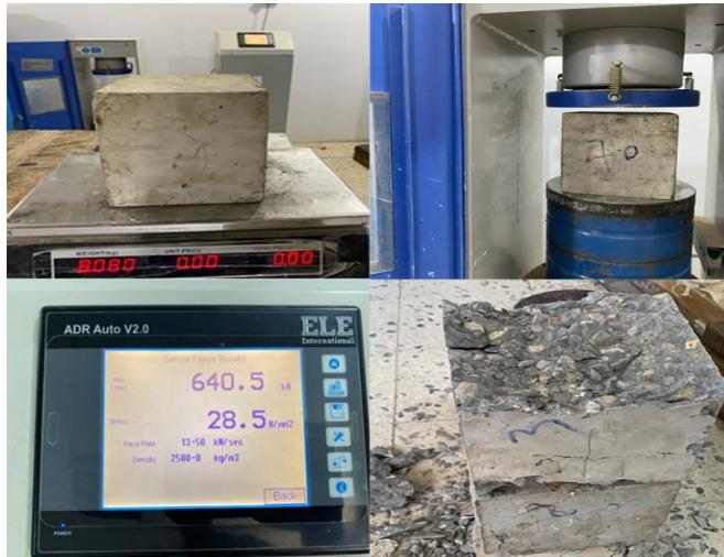
شكل 8 : نمط الانهيار لعينة معالجة بماء عند  $70^{\circ}\text{C}$
