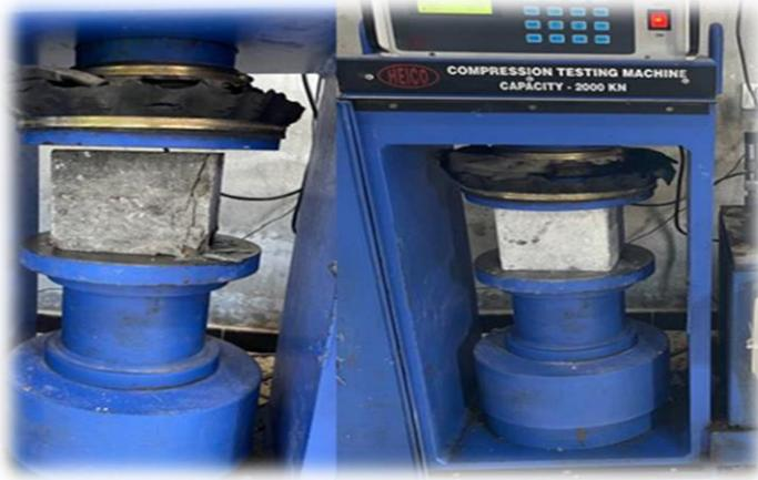
شكل 7: اختبار مقاومة الضغط لمكعب خرساني للعيينة C25
